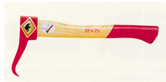
Handsappie Zum Heranziehen und Bewegen von schwächerem Holz und Schnittware Kopfgewicht 600 g
